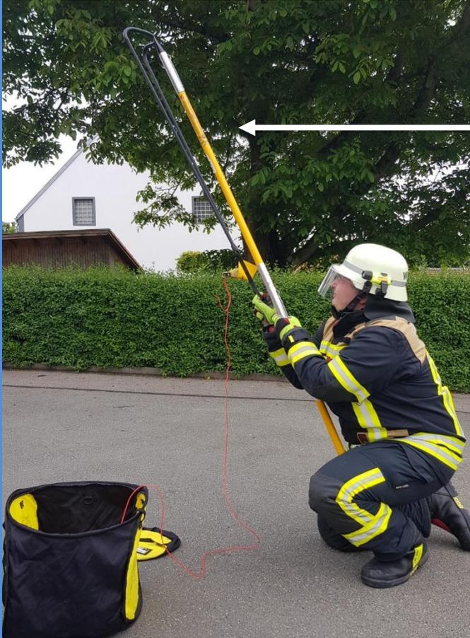
Eine dünne Leine wird mit einem Wurfbeutel über das Dach geschleudert.
