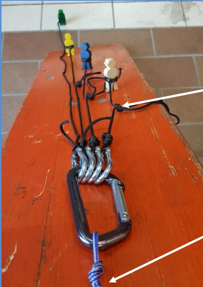
Die Längen der Feuerwehrleinen können gekürzt werden, um einen sicheren Aufstieg zu garantieren (Methode des Haltens, Sicherungsseil ist dabei ständig straff).
