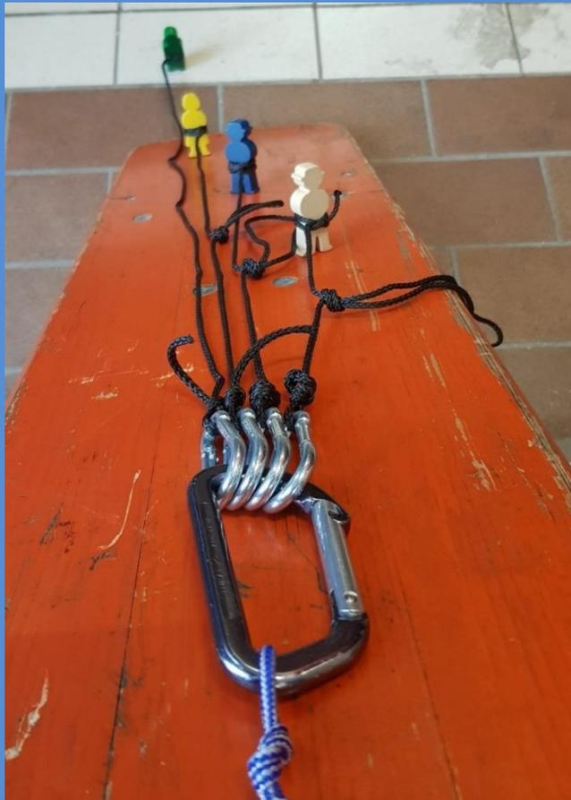
Sobald die letzte Person das Dach betreten hat, wird die Länge des Sicherungsseiles so fixiert, dass die unterste Person zirka zwei Meter vor der Absturzkante steht. Jetzt können die Knoten zum Verkürzen gelöst werden und sich alle am Dach frei bewegen. Methode ist dann ein Rückhalten, welche bei sehr flachen Dächern angewandt wird.
